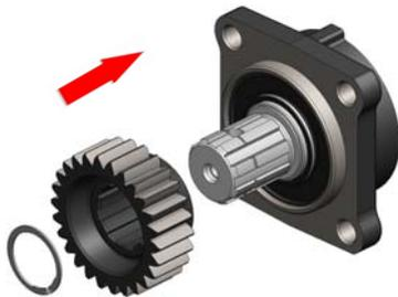
1 - Monte a engrenagem motriz e o anel elástico no eixo da bomba.
